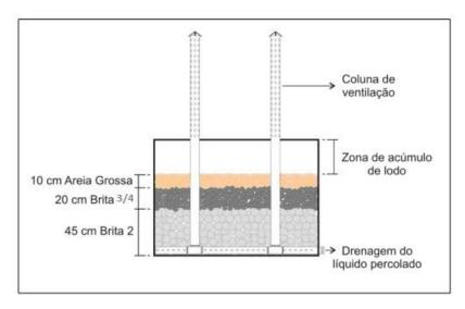
Figura 2. Disposição do leito filtrante. Fonte: Adaptado de Suntti (2010).
